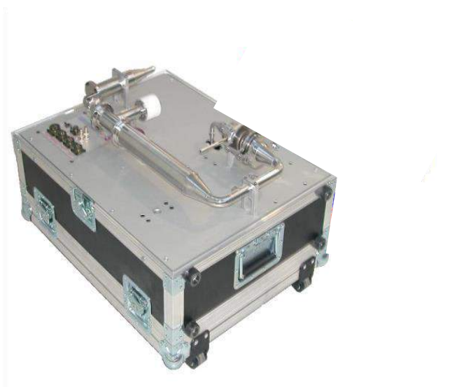
Figuur 10: Deeltjesmeetsysteem voor gravimetrische bepaling
