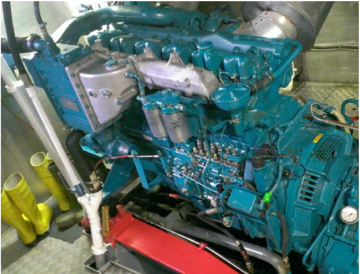
Figuur 2: Stuurboordaandrijfmotor MAN D2866 LXE43
