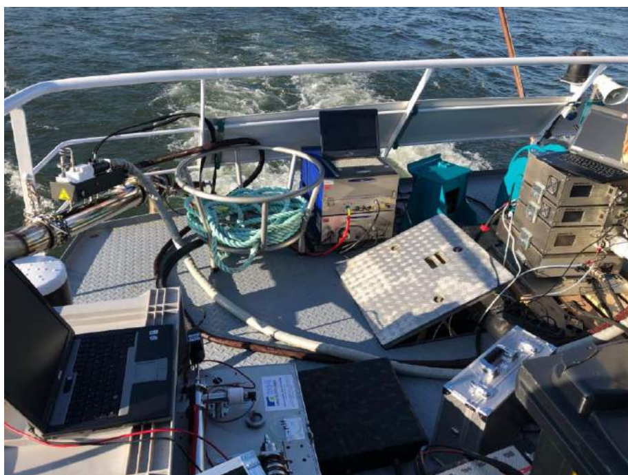
Figuur 14: Opstelling van het systeem voor de meting stroomafwaarts AGN "End of Pipe" (gasvormige, deeltjes- / roet- en uitlaatgasmassastroom)
