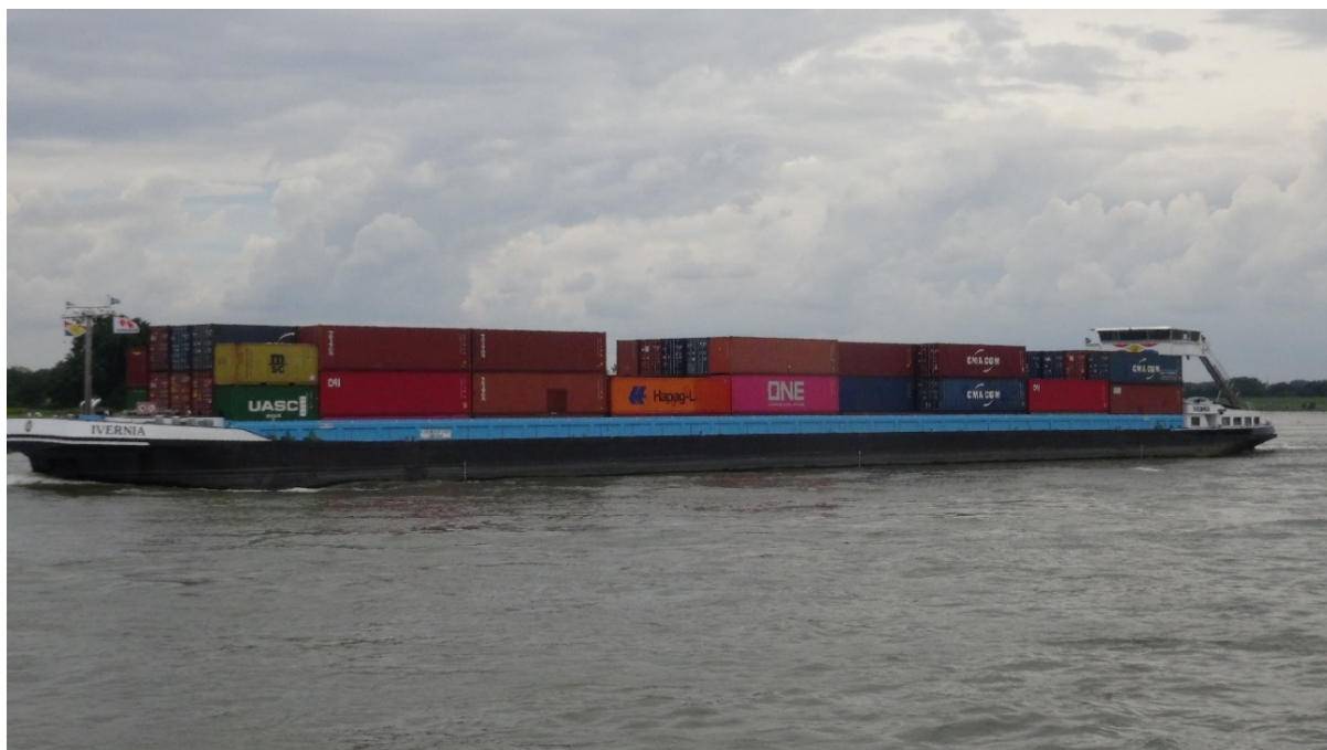
Abbildung 17: Das Containerschiff „IVERNA“ gehört mit 135 Länge und 14,2 m Breite zur Jowi-Klasse (Foto: Busch, LANUV)
