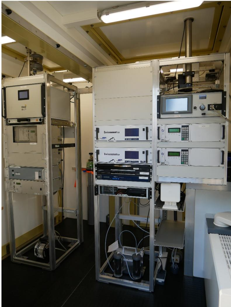
**Abbildung 4:** Innenansicht eines Messcontainers mit Mess- und Aufzeichnungsgeräten (Foto: LANUV)
