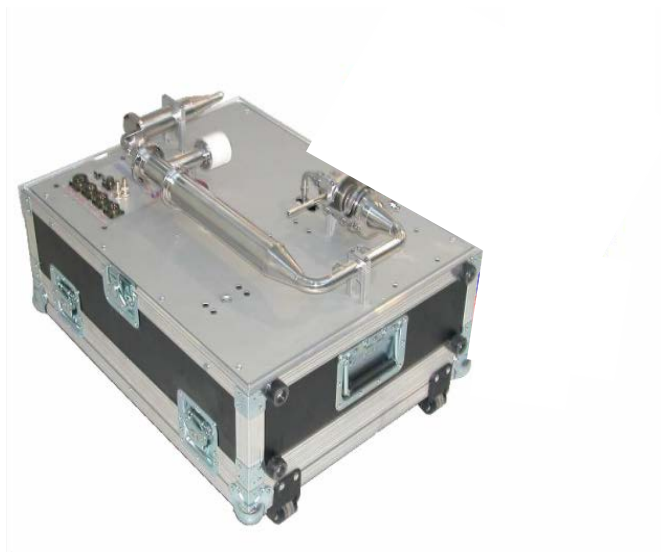
Abbildung 10: Gravimetrisches Partikelmessgerät Micro PSS. Quelle: Control Sistem
