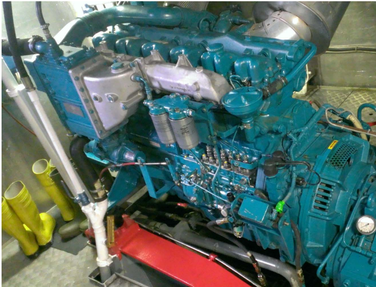
Abbildung 2: Antriebsmotor steuerbordseitig MAN D2866 LXE43
